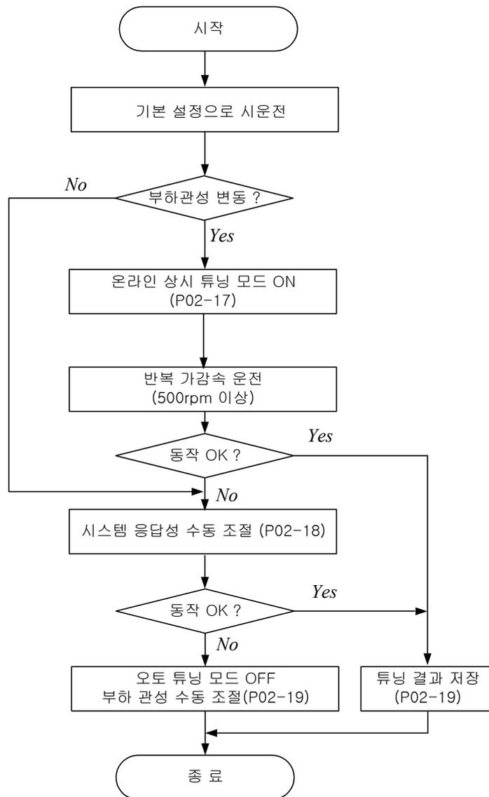
♥ 오토 튜닝은 수동 설정부인 시스템 응답성 설정(P02-18)에 의해서 위치 비례이득, 속도 제어 비례이득, 속도 적분 시정수, 토크 지령 필터 시정수가 설정되어지고 자동 조절부인 오토 튜닝 모드(P02-17)에 의해서 시스템 관성비(P02-19)가 설정됩니다.
