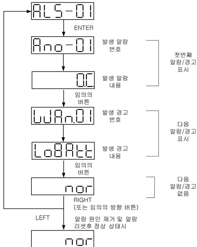
현재 발생 알람 표시 메뉴 ALS-01 은 현재 발생한 알람 및 경고를 표시합니다. 다른 메뉴로의 이동은 자유로우나 알람이 리셋(Reset) 되지 않으면, 모터의 동작은 불가능합니다.
