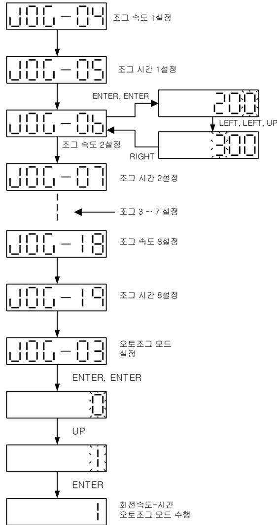
FDA7000 에서 오토 조그 모드는 8 개의 반복 패턴 동작을 지원하며, 각각의 패턴은 회전 속도[rpm], 회전시간[sec]으로 설정되는 제 1 오토 조그 모드와 회전속도[rpm], 회전량[rev]으로 설정되는 제 2 오토 조그 모드가 지원됩니다.
