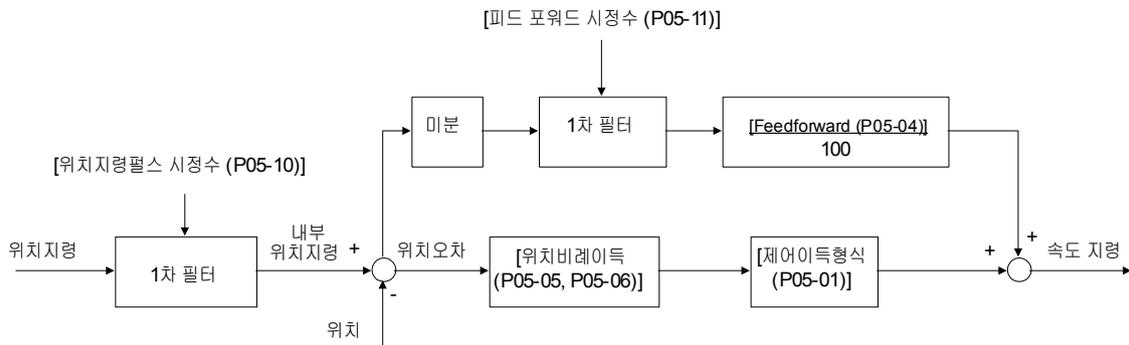
㉞ SERVO ON, STOP 상태이어도 위치 지령 펄스를 입력 받기 때문에 STOP 해제 시, 반드시 펄스 클리어 (PLSCLR)를 시켜 누적된 지령 펄스를 클리어 시킨 후, STOP 을 해제하시기 바랍니다.
