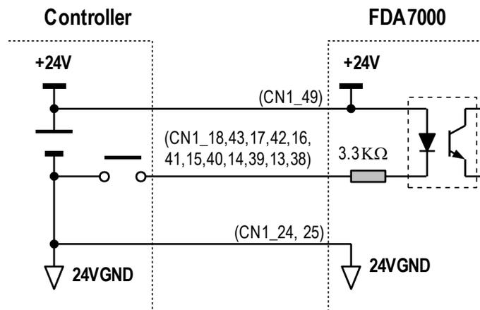
입력 접점을 PLC 또는 포토 커플러(Photo Coupler)로 사용하는 경우는 다음과 같이 서보 드라이브와 연결하여 주십시오. 이때, 외부 전원은 +24[V], 50[mA] 이상의 전원을 사용하여 주십시오.
