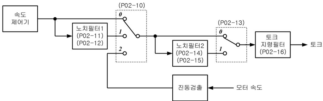
기계적인 공진을 억제하기 위한 공진 주파수와 공진 대역폭은 아래 그림과 같습니다. 공진 주파수는 [Hz] 단위로 표시되고, 공진 억제를 위한 대역폭은 0 에서부터 공진 주파수까지의 범위에 대한 일정 이득구간을 [%] 비율로 표시합니다. 따라서, 사용자 메뉴에서 공진 주파수 대역폭을 작게 설정하면 실제 노치 필터의 대역폭은 매우 커지게 되고 공진 주파수 대역폭을 크게 설정하면 노치 필터의 깊이가 얇게 설정됩니다.
